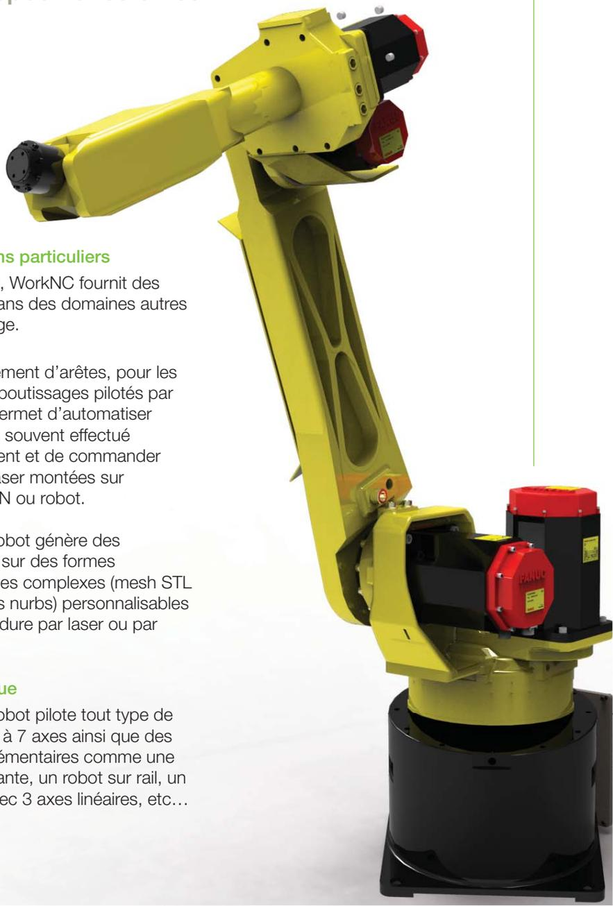
WorkNC intègre le module WorkNC Robot pour la simulation et l'édition de parcours d'outils pour piloter tout type de robot. WorkNC Robot utilise l'ensemble des parcours de WorkNC pour des opérations d'usinage, de durcissement d'arêtes, de soudure et de polissage.
