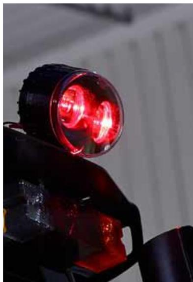
L'avantage de ce modèle 783 très fin est qu'il peut être monté directement contre le mât ou sur la traverse d'un chariot élévateur plutôt que sur le protège conducteur.
