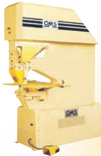
Poinçonneuse spéciale avec grand col de cygne et posage spécifique
