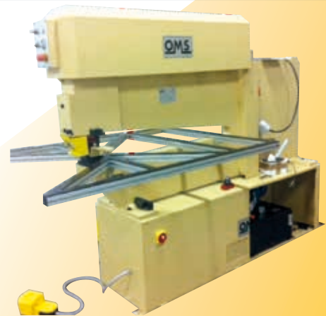
Poinçonneuse spéciale avec grand col de cygne et posage spécifique
