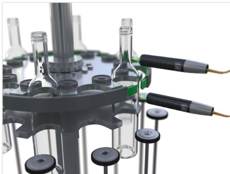
Mesure d'épaisseur rapide à deux canaux des bouteilles en verre dans le processus de production industriel.
