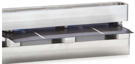
Mesure d'épaisseur des wafers dans trois voies de mesure.
