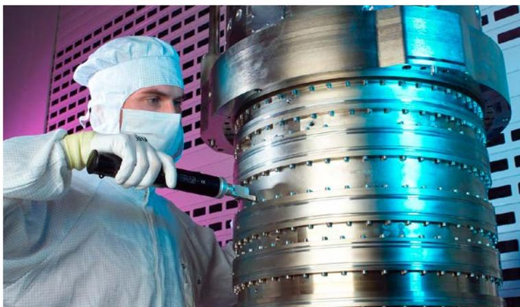
Les capteurs capaNCDT sont utilisés pour procéder à l'ajustement nanométrique des lentilles des objectifs pour l'exposition des tranches de silicium.
