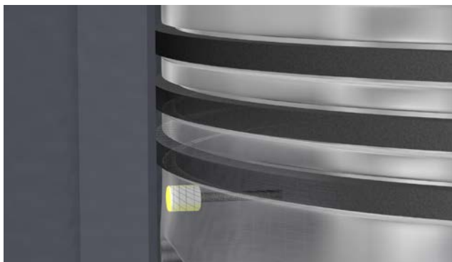
Surveillance de la fente de lubrification dans le moteur à combustion
