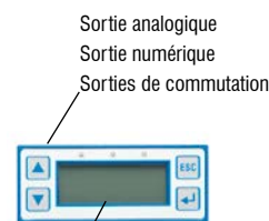
Contrôleur externe : commande simple et affichage des valeurs de mesure (inclu dans le livraison)
