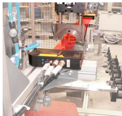
Détection de la coquille de coussinet dans la construction d'automobiles
