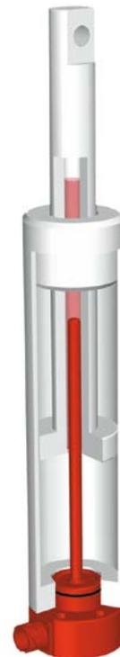
Série EDS : Montage dans un vérin hydraulique
